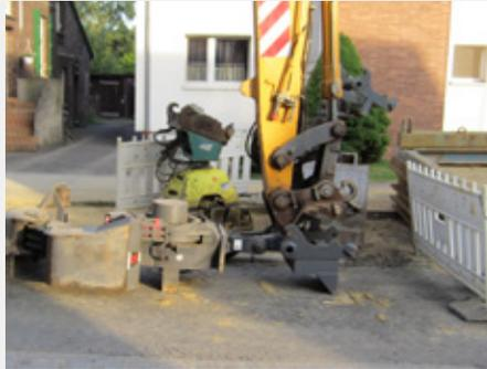
**02** Die hydraulische Verbindung erfolgt mit einer Leitungskupplung.
