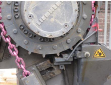
**01** Die Rückschlagsicherung wird eingerastet.
